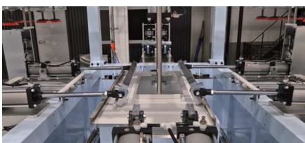
4. 유리가 깨지지 않도록 토크 조절로 알루미늄 프레임 자동 분리
